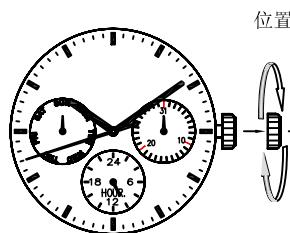
将表冠拔出至位置一，按箭头方向旋转表冠，检查机芯快速设定日期功能
